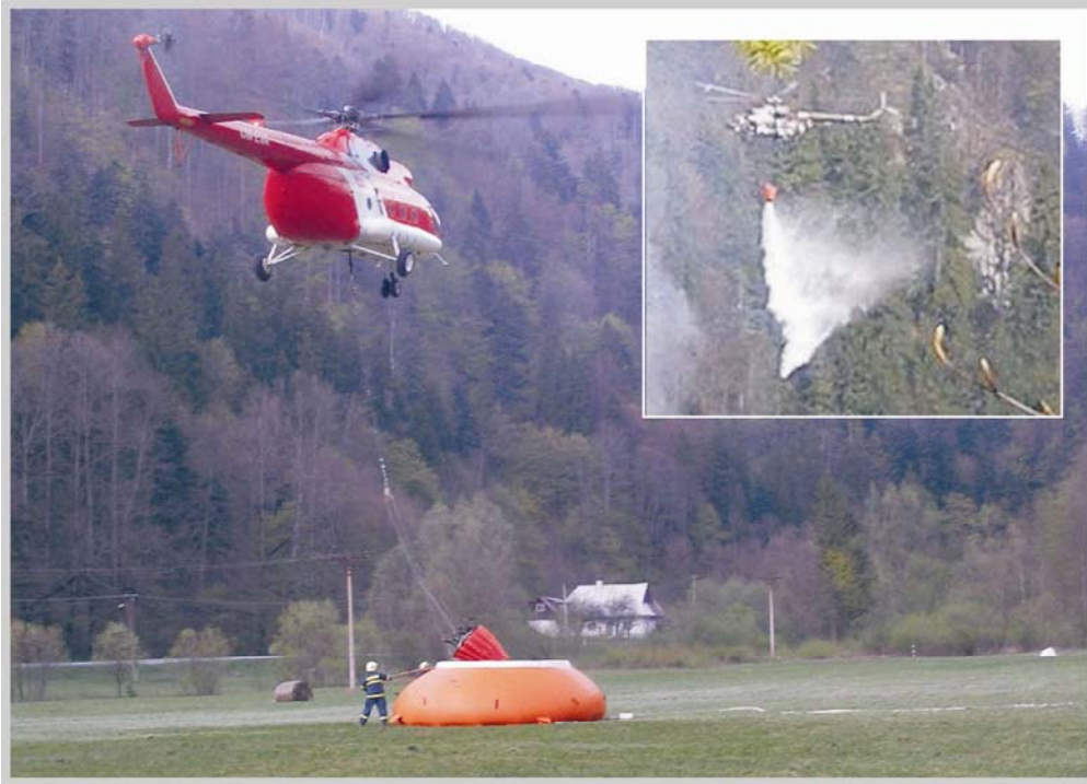
Obr. 3. Plnenie hasiaceho vaku z veľkoobjemovej nádrže Fireflex (38 m 3 ),
